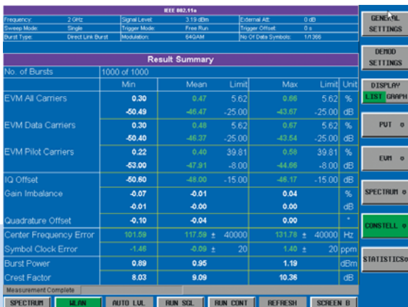
Bild 2: Anzeige der wichtigsten Modulationsparameter in der Result Summary: Die Messung über 20 Bursts zeigt einen EVM von -46,7 dB für den besten (Min peak) und -45,09 dB für den schlechtesten Burst (Max peak) sowie einen mittleren EVM über alle Bursts von -46,09 dB. Gleichzeitig werden die Ausgangsleistung (burstbezogen) und der Crest-Faktor angezeigt. Somit lässt sich beispielsweise die Abhängigkeit des EVM von der Ausgangsleistung eines Verstärkers schnell und einfach bestimmen. Durch die Autolevefunktion des Analysators folgt dieser Pegeländerungen, ohne dass manuelle Eingaben nötig werden.
