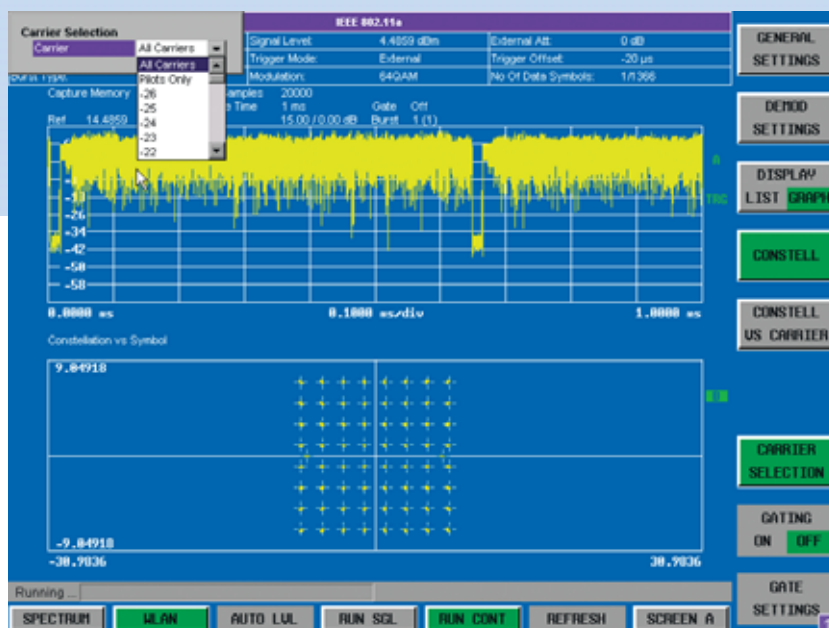
Bild 3: Konstellationsdiagramm aller oder (wählbar) einzelner Träger
